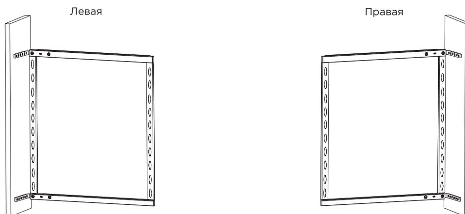
Установите фасадные крепления. При необходимости отрегулируйте фасад.
