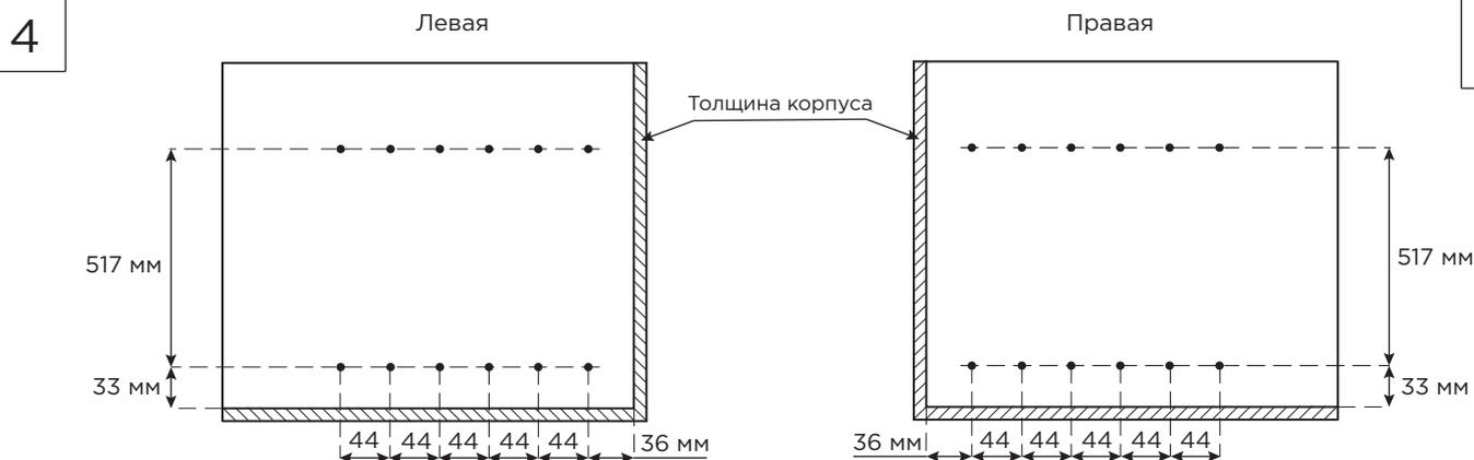
Если система устанавливается в корпус с выдвижным фасадом, сделайте разметку фасада для установки фасадных креплений.
