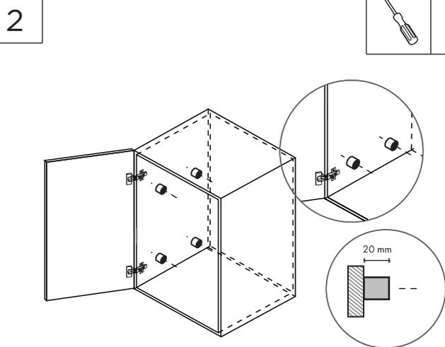
Если система устанавливается в корпус с распашным фасадом, со стороны петель установить проставки под направляющие.
