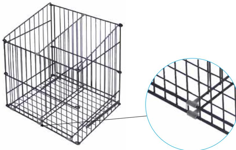
Вставьте пластиковые фиксаторы (5) с торцов утолщенной проволоки дна (3) и перегородки корзины (4). Установите дно (3) и перегородку (4) в корзину (1) и прижмите фиксаторы (5) до щелчка.
